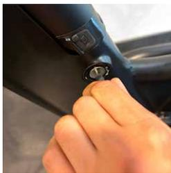
3. Lors de la réinsertion de la batterie, vous devez d'abord retirer les clés de vélo de l'antivol de la batterie. Ensuite, vous devez d'abord mettre le haut de la batterie dans le vélo, puis le bas (comme indiqué sur la photo) jusqu'à ce que vous entendiez un « Clic » et que la batterie soit verrouillée dans le vélo.
