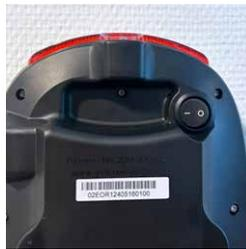
4. Il y a aussi un bouton allumer/éliminer sous la batterie, si vous éteignez cet interrupteur, la batterie ne fonctionnera pas dans le vélo.
